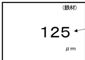
通常モードでは、プローブを押し当てたときの1測定値が保持（表示）されますが、連続測定モードでは、プローブを押し当てている間約0.5秒毎に測定値を取込み、表示します。
